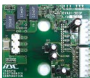
Super mini DIIPM™ evaluation board EVA11-SDIP
